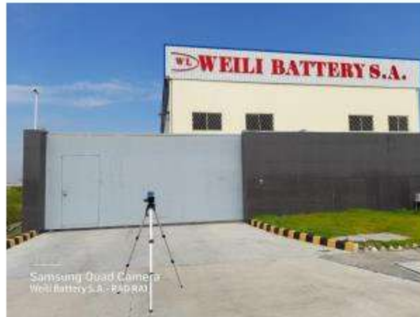
Fotografía 1: Monitoreo de ruido ambiental: RA01 – Lindero exterior
