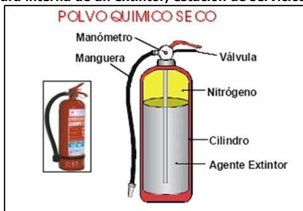
Gráfico 71: Estructura interna de un extintor, estación de servicios "SIMON BOLIVAR".
