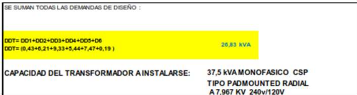
Gráfico 79: Capacidad del Transformador, estación de servicios "SIMON BOLIVAR".
