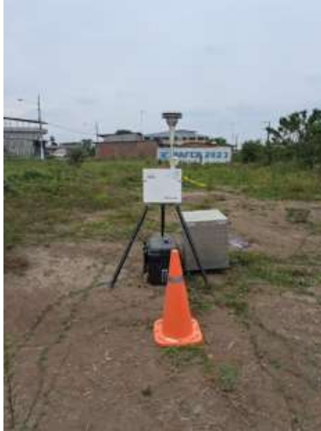
Gráfico 107: Equipo de Aire – Material Particulado PM 2.5 y PM 10 en el área de construcción de la estación de servicios "SIMÓN BOLÍVAR".
