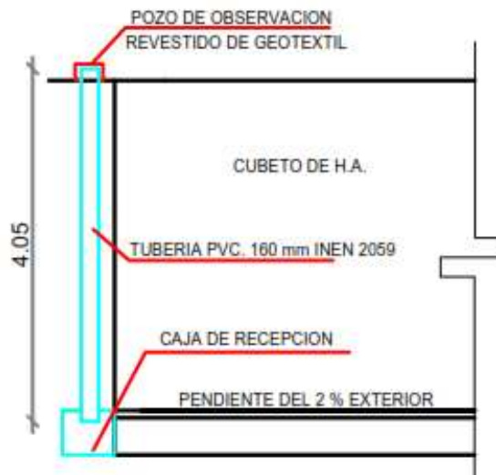
SISTEMA DE MONITOREO EXTERIOR ESCALA: 1-----S/E
