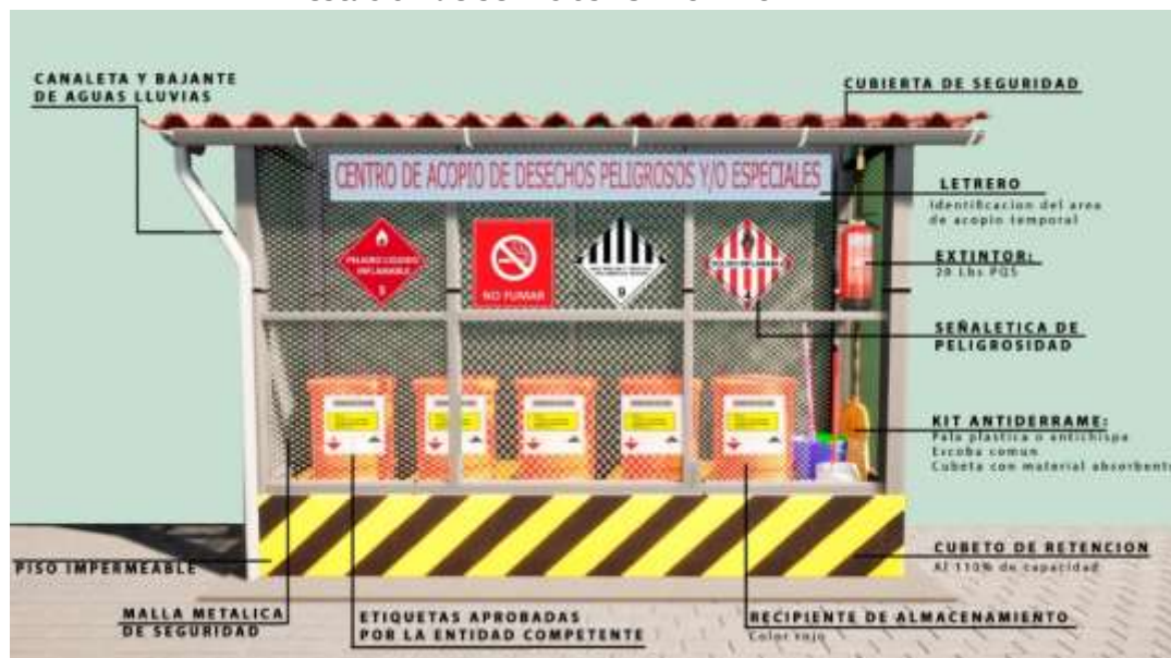
Gráfico 211: Adecuación del centro de acopio de desechos peligrosos y/o especiales, estación de servicios "SIMON BOLIVAR".
