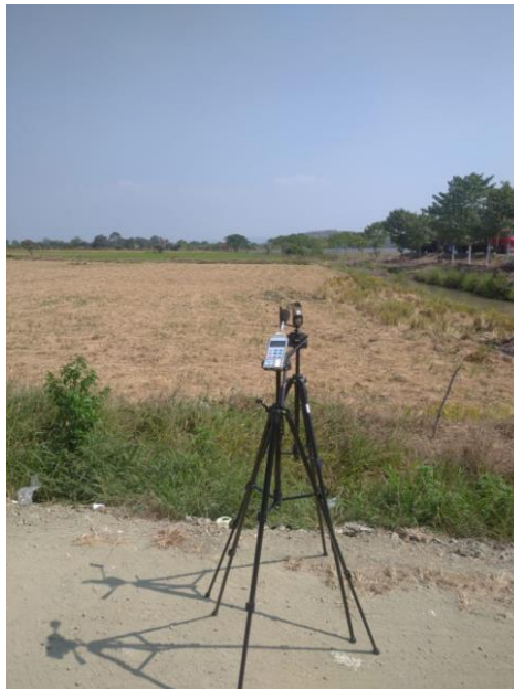
Gráfico 120: Equipo de Aire – Ruido Ambiental utilizado en el área de construcción de la estación de servicios "COOPERATIVA DE TRANSPORTES PASCUALES".
