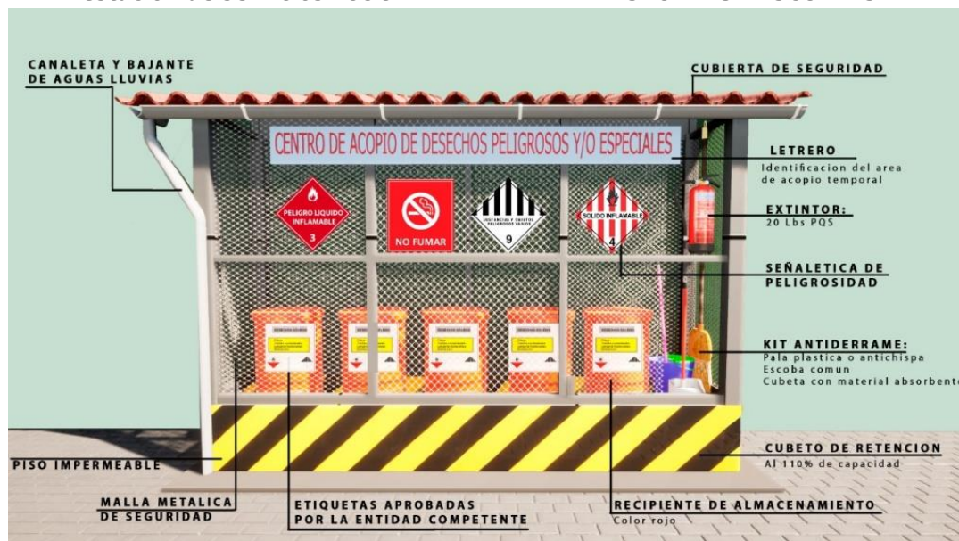
Gráfico 212: Adecuación del centro de acopio de desechos peligrosos y/o especiales, estación de servicios "COOPERATIVA DE TRANSPORTES PASCUALES".
