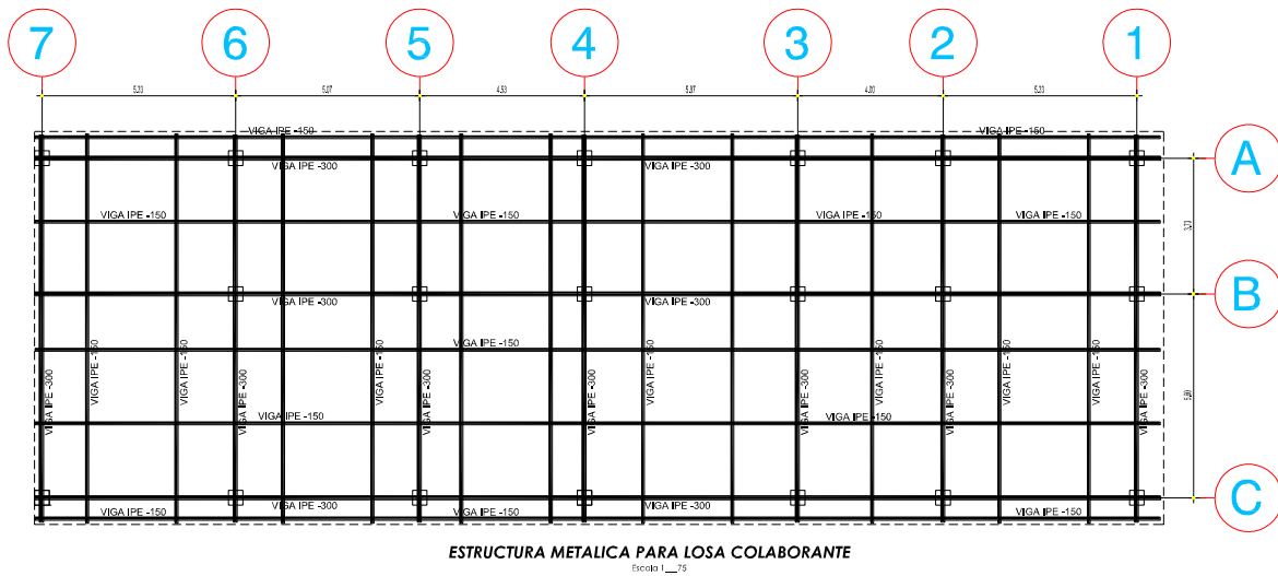
Gráfico 52: Cálculo Estructural – Estructura metálica para losa colaborante, estación de servicios "COOPERATIVA DE TRANSPORTES PASCUALES".
