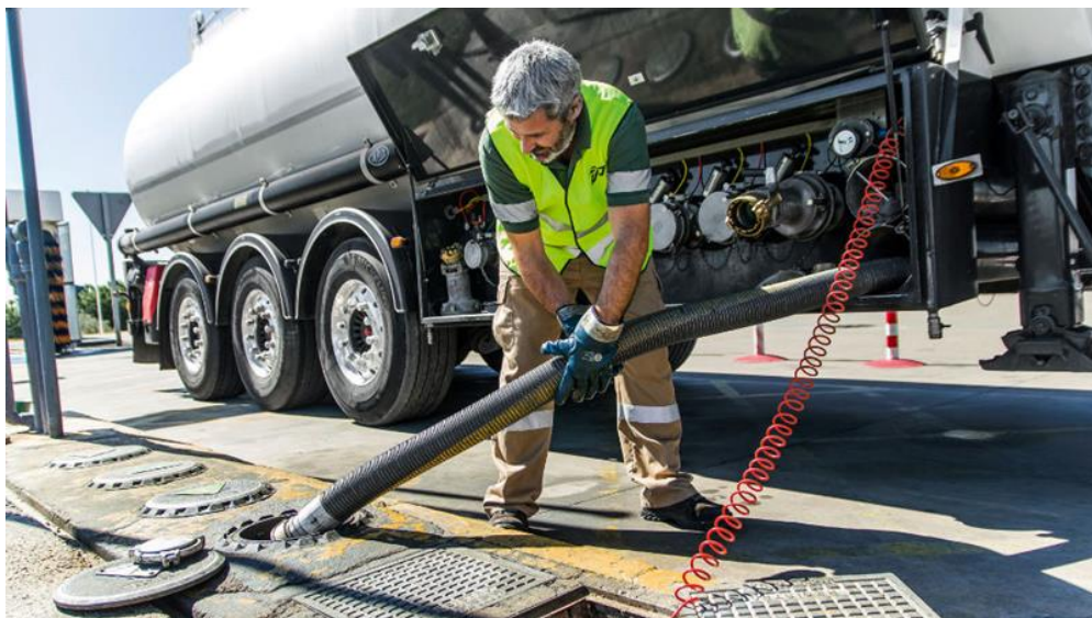
Gráfico 84: Red de Carga y Descarga, estación de servicios "COOPERATIVA DE TRANSPORTES PASCUALES".
