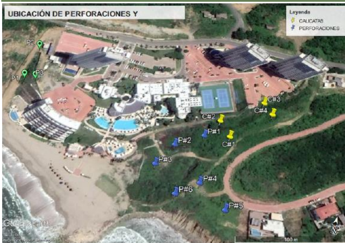
Figura 5 Ubicación de perforaciones y calicatas. Fuente: Informe de estudio de suelos, Construladesa.
