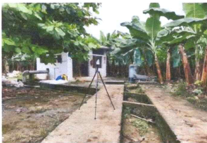
Ilustración 9 Instalación del sonómetro para mediciones de ruido ambiente. Estación de bombeo 1(riego subfoliar)
