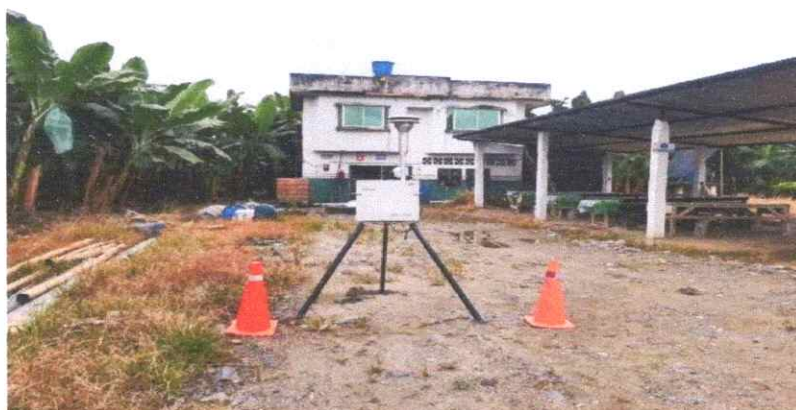
Ilustración 18 Equipo instalado para mediciones de calidad de aire y material particulado estación de bombeo 2 (riego gran cañón).
