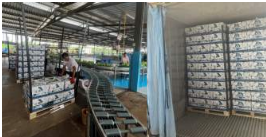
Fotografía 1-11. Paletizado de cajas de banana y colocación en contenedor. Fuente: GODDCORP S.A., 2023.
