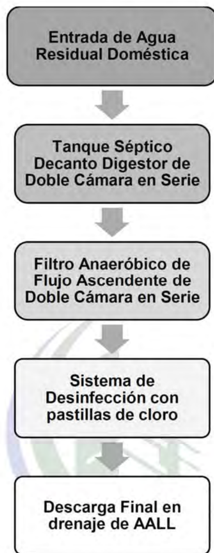
Ilustración 3.12. Diagrama de operación de la PTAR
