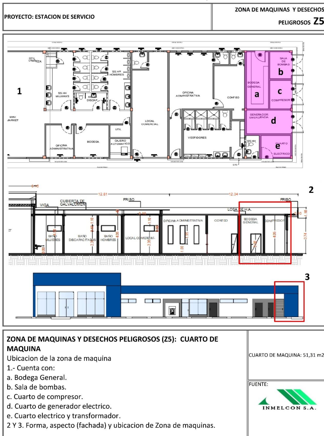
Gráfico 1.16 Cuarto de Máquinas
