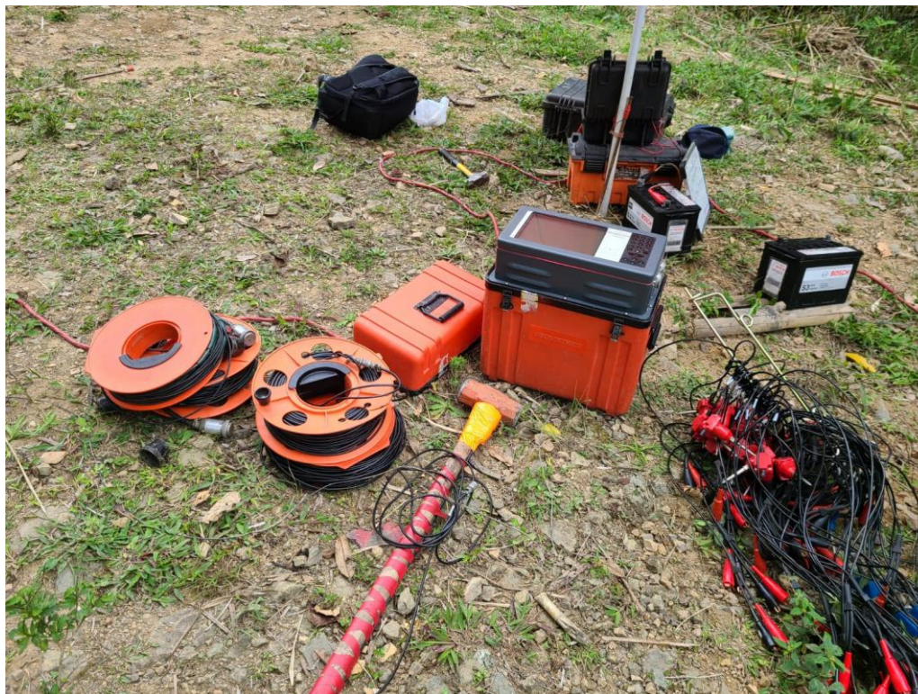
Figura 2.6, Equipo de medición eléctrica con accesorios
