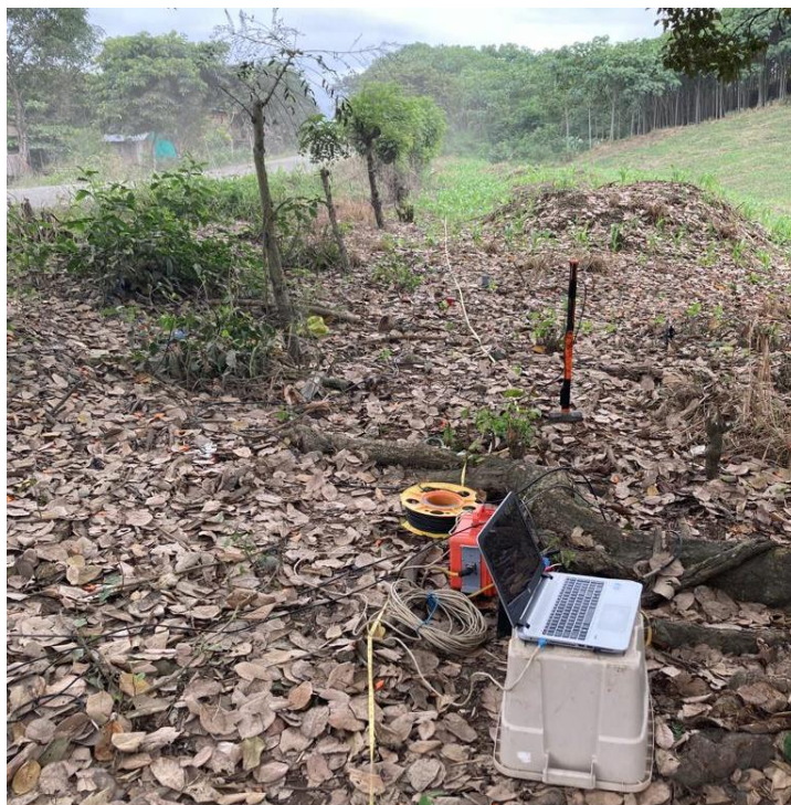
Foto 3. Arreglo geofísico Puente existente
