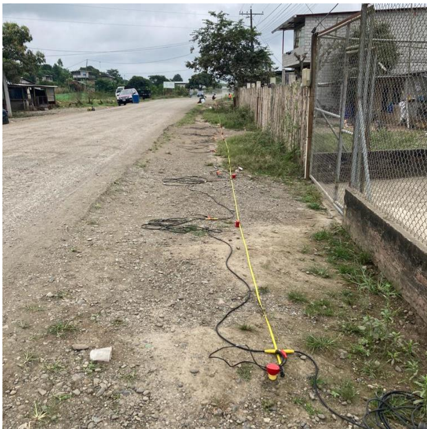
Foto 2. Arreglo geofísico Puente nuevo
