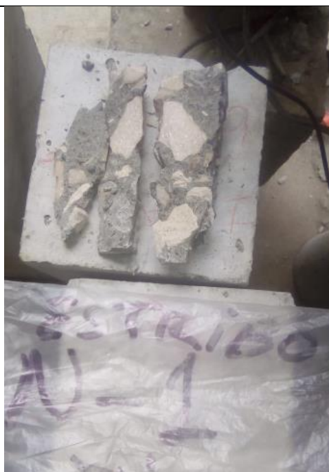
Ilustración B7. Núcleo de Ho. del estribo ensayado
