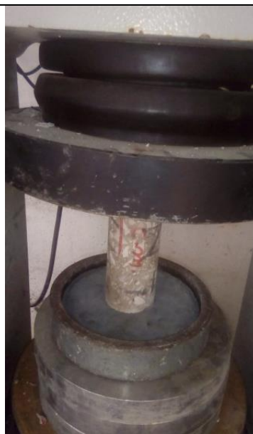
Ilustración B6. Ensayo de compresión del núcleo de hormigón.
