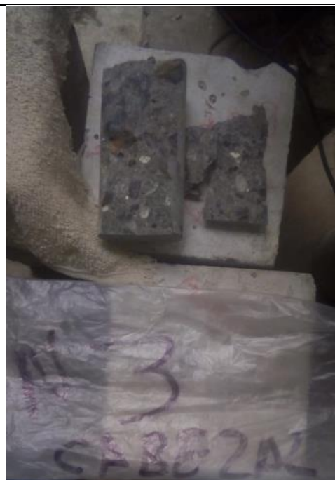
Ilustración B8. Núcleo de Ho. de la viga cabezal ensayado
